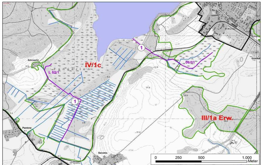
**Ausgangssituation:** Bei den Gräben L52/1 und 06/01 handelt es sich um die beiden wichtigsten Zuflüsse zum Schmachter See. Sie waren stark verschlammmt und hoch mit Nährstoffen belastet.
